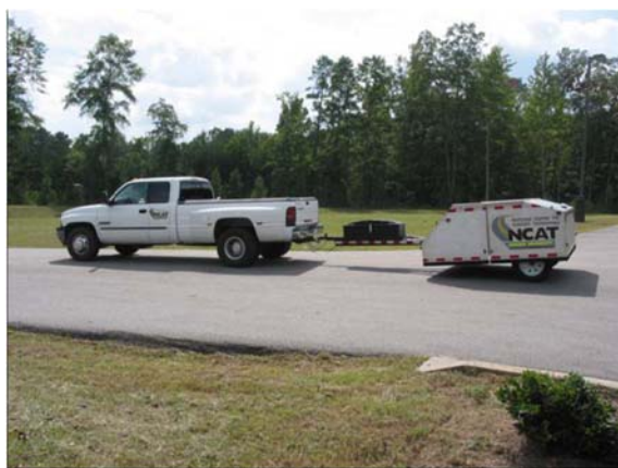
图 T 0987-3 拖车式CPX测试方法
