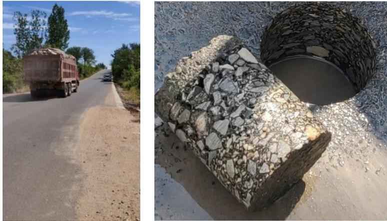
实体工程， 取芯照片（水稳基层超级油石界面）
